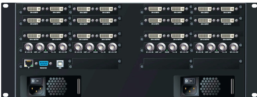
Вид задней панели процессора с разными вариантами установленных модулей: вверху – по 16 входов/выходов DVI-U, внизу – 20 входов (16×DVI-U + 4×3G-SDI) и 12 выходов (8×DVI-U + 4×3G-SDI)
